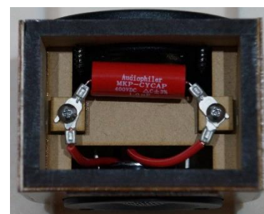
底面取付けのハイパスフィルタ用コンデンサ
